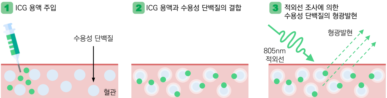
[ 그림 2-1 ] ICG Camera System 원리
